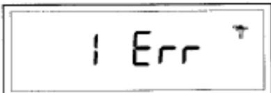
Это происходит до тех пор, пока Вы не нажмете на любую кнопку. Контроллер будет обеспечивать полив всех других зон. Этот процесс будет повторяться до исчезновения короткого замыкания.
